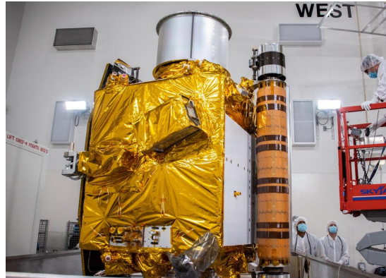
Figura 3.2: La sonda DART appena installata sul payload adapter. Al centro è possibile vedere il dispenser di LICIACube. (NASA/JHU-APL)
